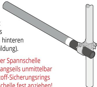
7. Anschließend Shooter mit der Spannschelle eines dafür vorgesehenen Fangseils **unmittelbar oberhalb des hellen Kunststoff-Sicherungs-rings absichern (Vorschrift). Ringschelle fest anziehen!**
